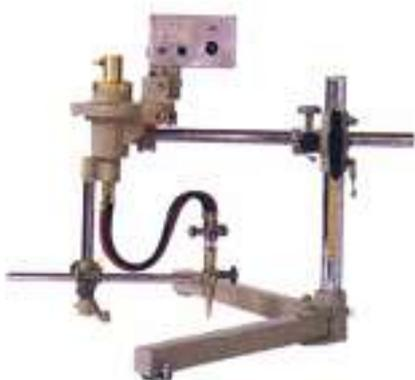
**Машина термической резки КС-600 (фланцerez)** специально разработана для вырезки отверстий, кругов и фланцев из листового материала толщиной до 100 мм в условиях металлообрабатывающих предприятий и на строительно-монтажных площадках при температуре окружающего воздуха от +5° до +35°С и относительной влажности до 80%.
