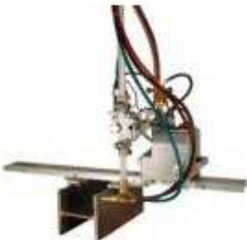
**Машины серии КС-2Н** предназначены для автоматизированной резки двутавровых балок и швеллеров с высотой 150 до 1600мм. Перемещение резака и машины осуществляется с помощью электродвигателей с плавной регулировкой скорости. Управление осуществляется с помощью джойстика. Резка может осуществляться не только перпендикулярно к продольной оси балки, но и под углом к ней до 45 градусов.
